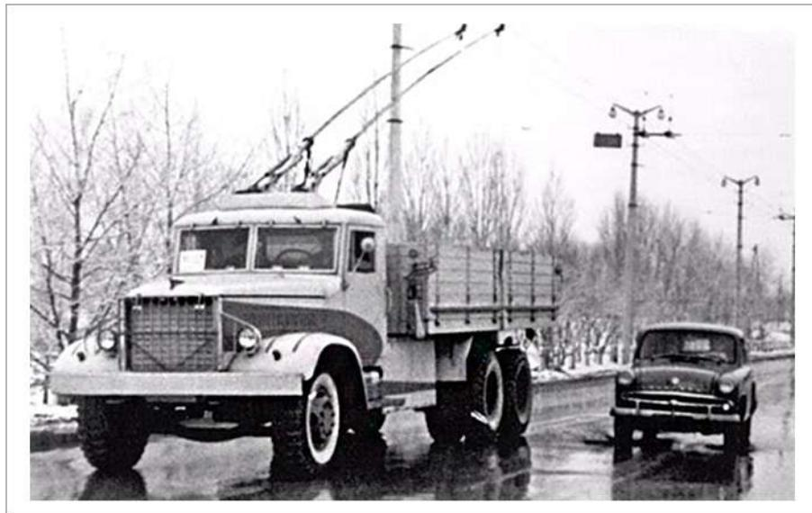
Рис. 9. Грузовой троллейбус
